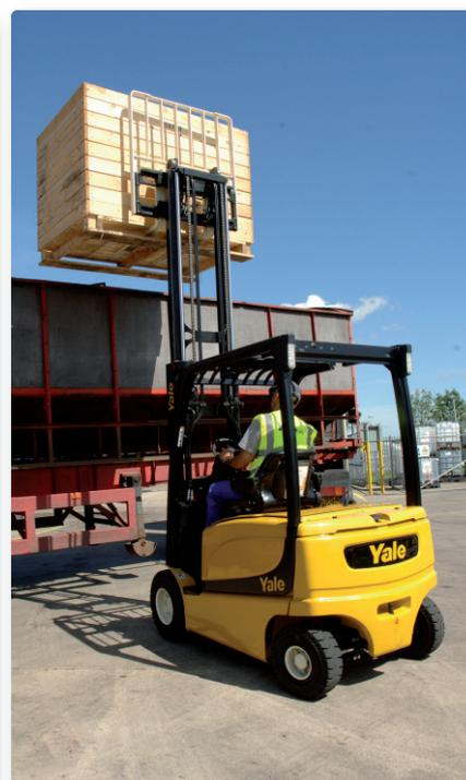
parking électrique, ainsi qu'au CANbus et à la technologie du courant alternatif. La transmission entièrement étanche ne nécessite aucune maintenance hormis une vidange à 4000 heures. Les feux à LED sont disponibles en option.
