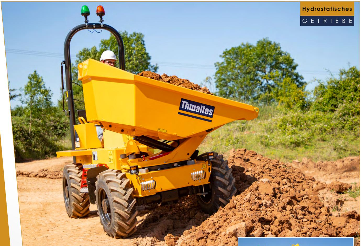
Der Thwaites 2,3-Tonnen-Drehkipper (Stufe V) wird unter Berücksichtigung der Bedürfnisse von Bauunternehmern und Maschinenvermietern hergestellt: Er gewährleistet die Sicherheit des Fahrers, reduziert Unfallrisiken auf der Baustelle und verbessert die Leistung. Angetrieben von einem Yanmar-Dreizylindermotor mit 18,1 kW, der für optimale Traktion ein Drehmoment von 107 Nm liefert, verfügt dieser Kipper über ein hydrostatisches Getriebe, das seine Bedienung sehr einfach und unkompliziert macht.
