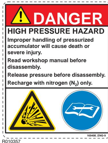
Nel martello è incorporato un accumulatore di pressione. L'accumulatore viene pressurizzato anche in assenza di pressione idraulica nel martello. Il tentativo di smontaggio dell'accumulatore senza prima averlo depressurizzato può provocare infortuni, anche mortali. Non cercare mai di smontare accumulatori di pressione; rivolgersi sempre al concessionario di zona.
